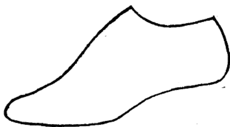
图 12 侧面中跟女鞋楦外形轮廓图
