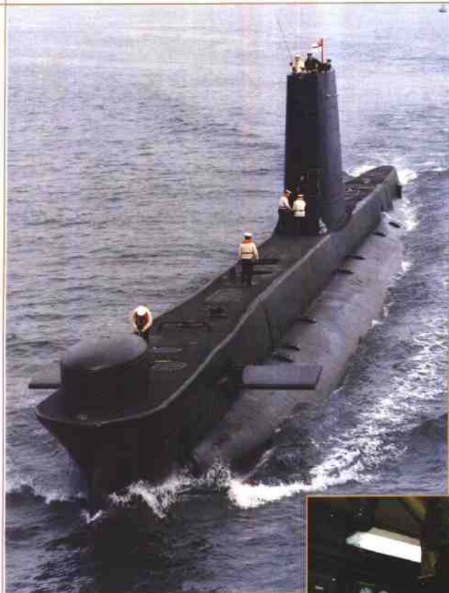
“海狮”号是英国皇家海军8艘“小鲸”级潜艇之一。她建于20世纪50年代，吸收了XXI型潜艇的设计思路 and 战时经验，装备了Mk8型和Mk20型鱼雷。
