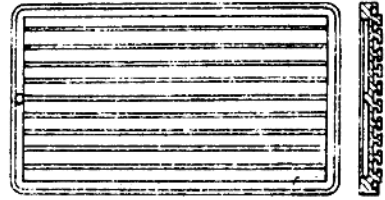
图1-3 带槽的铸铁底板
