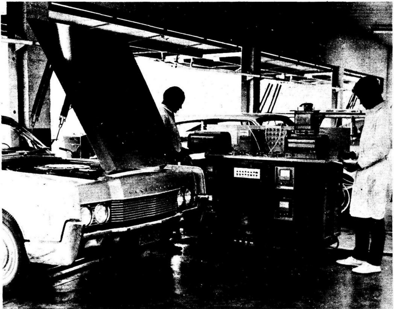
州檢驗員正在試驗操作一段時間後的車輛以便決定為新車而設立的標準發生多少偏差。從這方法得到的資料稍後能呈獻給立法機關來加強舊車實施強迫檢驗的重要性。
