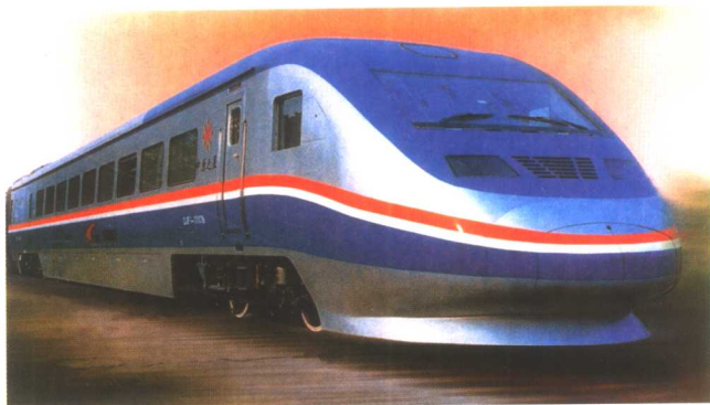
照片6 我国的高速铁路机车 “中原之星”电动车组(速度 160km/h, 功率3600kW, 由株 洲电力机车厂、株洲电力机车研 究所、四方机车车辆厂联合研 制)(上图)
