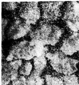
第 2 - 1 圖 伊豆砂砂的碎粒， \times 20 20 \sim 60\text{mesh} (37.09 \%)
