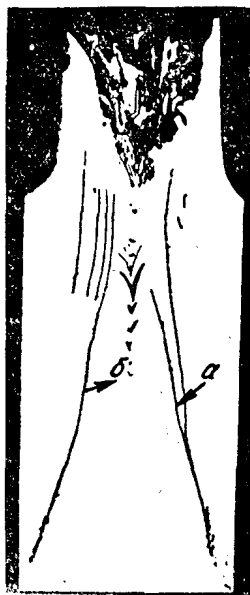
圖9 10.5噸的鋼錠結構簡圖：
