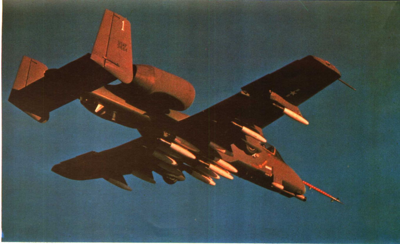
▲美國空軍的新式攻擊機“快捷”A-10。可以攜帶18個Mr 82 500磅炸彈（見P.50）
