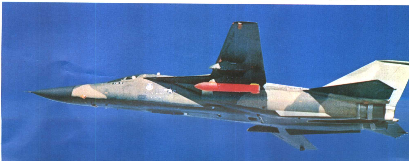
▼“通用”F-111變翼式戰鬥攻擊機，主翼下的紅色炸彈是B-77核彈（見P. 52）
