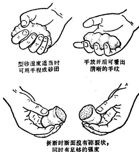
图 1-3 手捏法檢驗型砂
