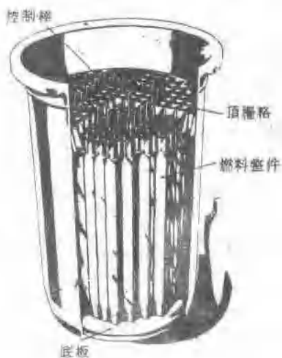
圖 5 上圖為賓夕法尼亞州·西賓堡原子發電廠的反應器核心，正降落在定位中。右下圖表示出這個核心的內部結構，燃料元件是鎖在頂柵格和底板之間，由於緊密的排列而達到臨界質量。連鎖反應所產生出來的熱是由通道中自下而上的冷却水所帶走的。圖中突出的棒狀物即為控制棒和安全棒。
