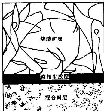
图 1-2 烧结过程 中料层横断面示意图
