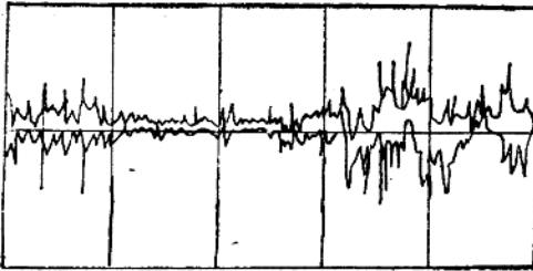
图13-1-4 轴承的振动波形
