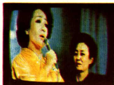
〈故障畫面13〉畫面上部過份延伸
