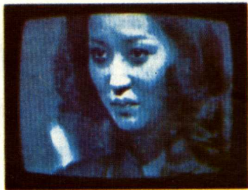
《故障畫面48》黑白畫面的白平衡偏離，畫面全體變成藍色。
