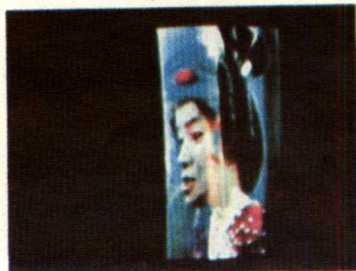
《故障畫面24》水平寬度不夠在中央重疊
