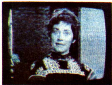
《故障畫面33》有彩色雜訊（於接收黑白節目時在畫面上出現有點狀的雜訊）
