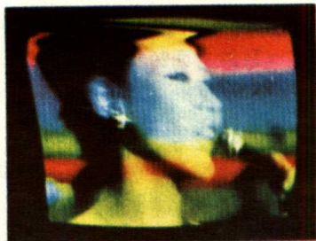
《故障畫面22》畫面上部彎曲，水平同步也很容易崩潰
