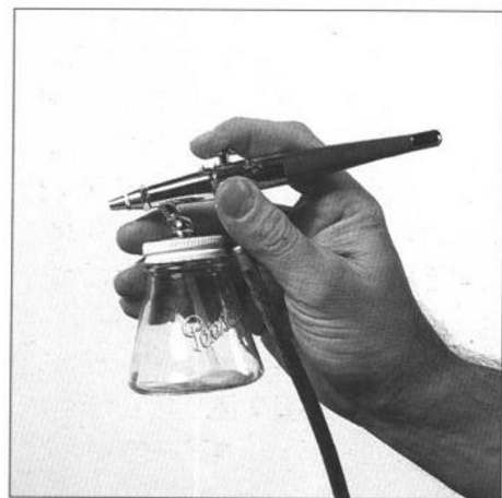
這個派司克式 (Paasche model VL) 噴槍通常用於T恤圖案。不像上面的艾瓦塔式噴槍。T恤插圖者的噴槍上有顏料瓶，能隨意改變。可任意使用這兩種噴槍，食指放在制輪機上以控制空氣和顏料量。
