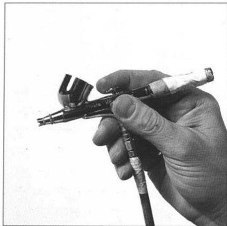
這本書中的廣告插圖是使用艾瓦塔式 HP-C (Iwata model HP-C)。就像許多廣告插圖者的噴槍，也附著一個顏料杯。在握處纏帶讓使用者較方便。
