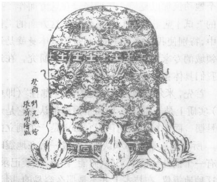
图 267 张衡公元 132 年所造世界上第一架地震仪的外形（由李善邦复原）
