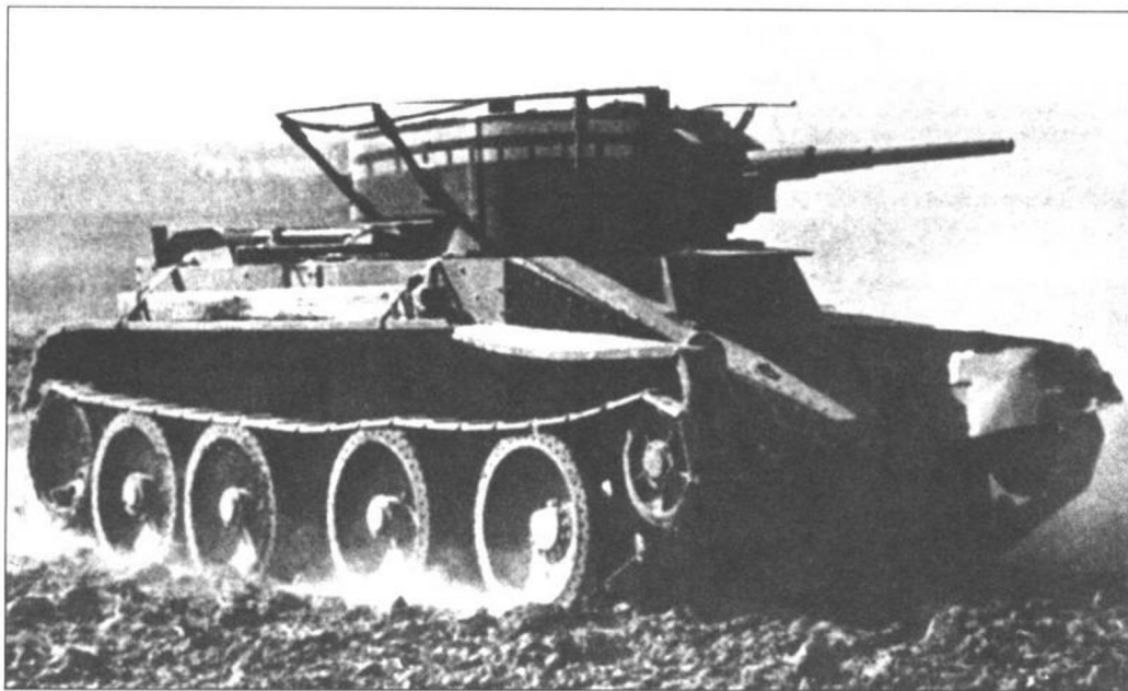
图为BT-5TU指挥坦克。BT系列坦克是苏联在一战和二战间生产的各种坦克中最成功的一个系列，由于采用了“克里斯蒂”式行动装置，具有很好的越野性能
