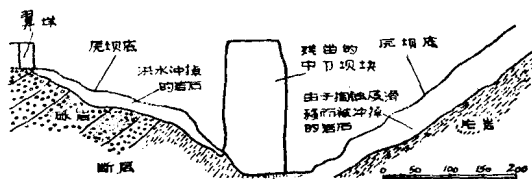
图绪1 美国加利福尼亚州圣弗朗西斯坝1928年冲垮之后, 沿坝轴线剖面图
