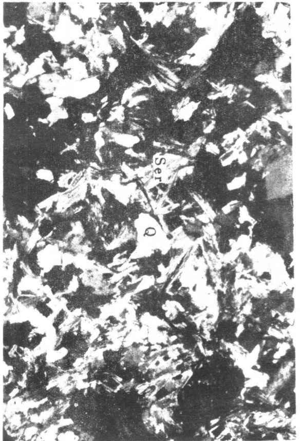
照片 22 绢英岩,原岩为斜长花岗岩。石英(Q)和绢云母(Ser)强烈交代原岩,原岩结构消失,变成鳞片花岗岩变量结构。绢云母呈片状或放射状杂乱地散布在石英颗粒间,石英呈他形粒状。25X
