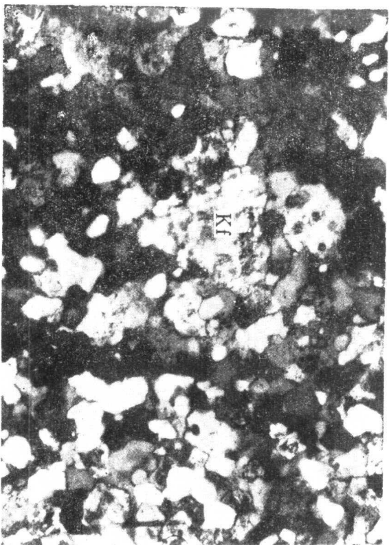
照片 5 钾长石化石英闪长斑岩。斜长石(Pl)斑晶被条纹长石(Per)交代,有的已全被条纹长石所取代。38X
