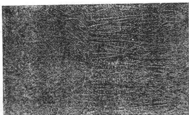
圖 128 鋼錠的組織（腐蝕後之肉眼組織）
