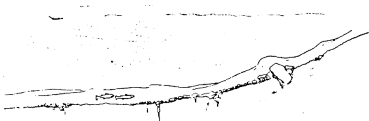
图3 具有粗颗粒沉积的山间小河。水的流速快。巨砾和较粗沉积物位于山脚下。细砾石和砂通常被冲刷到较远距离上。小河年复一年地沿着同一个路线流动。流动路线取决于地形，而且一般不会改变。粗颗粒金和金块可能进入裂缝和裂隙中
