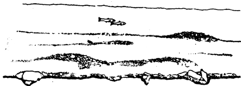
图5 在基岩与河床之间有一米左右沉积物的河流。金可能在许多历史很长的老河床中找到，主要在河的上游和沉积的底部，偶尔也能发现金块，但大多数金颗粒为中等尺寸
