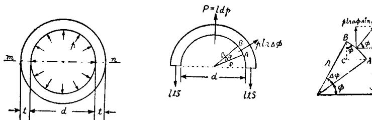
環的  $AB$  一部分的長為  $r\Delta\phi$ ，寬為  $l$ （與圓面垂直），故其面積為  $(r\Delta\phi)l = lr\Delta\phi$ 。該部分所受的壓力為  $p$  ( $lr\Delta\phi$ )，其垂直分力為  $plr\Delta\phi \sin \phi$ ，故半個環的總壓力為
