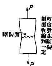
鑄鐵等不易延伸的脆性材料，其拉伸試驗圖如下圖所示。
