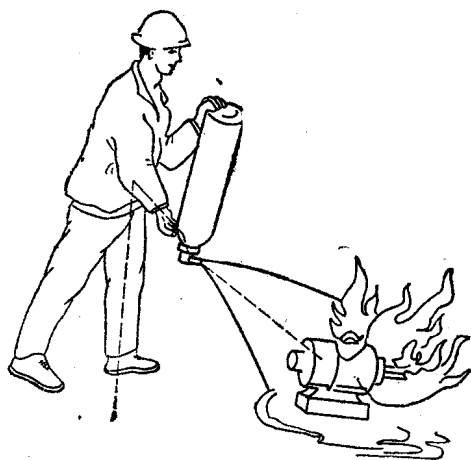
图2-10 导电溶液灭火的危险
