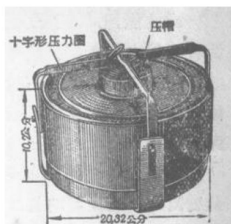
圖3 帶十字形压圈的反坦克地雷的構造
