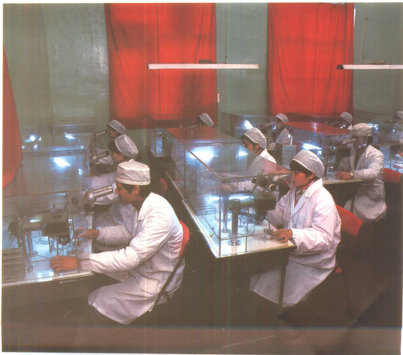
辽原电子元件厂生产3DG系列晶体管工序一角
