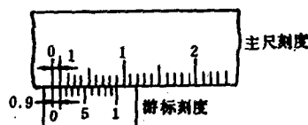
图 1-1.7 0.1毫米游标卡尺的刻线原理
