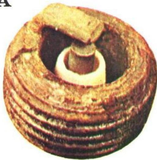
由於汽缸蓋鬆，火花塞未收緊，受熱過度時，外殼部份呈剝離狀態，應檢查損壞原因及火花塞螺紋長短度是否適當。
