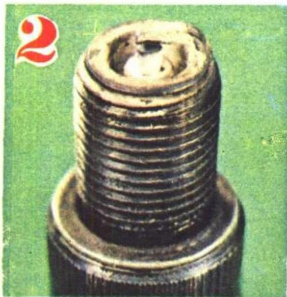
滿佈烟灰狀物體的，表示着火時間過早，或混合稀薄；同時，汽缸過熱亦有以致之。
