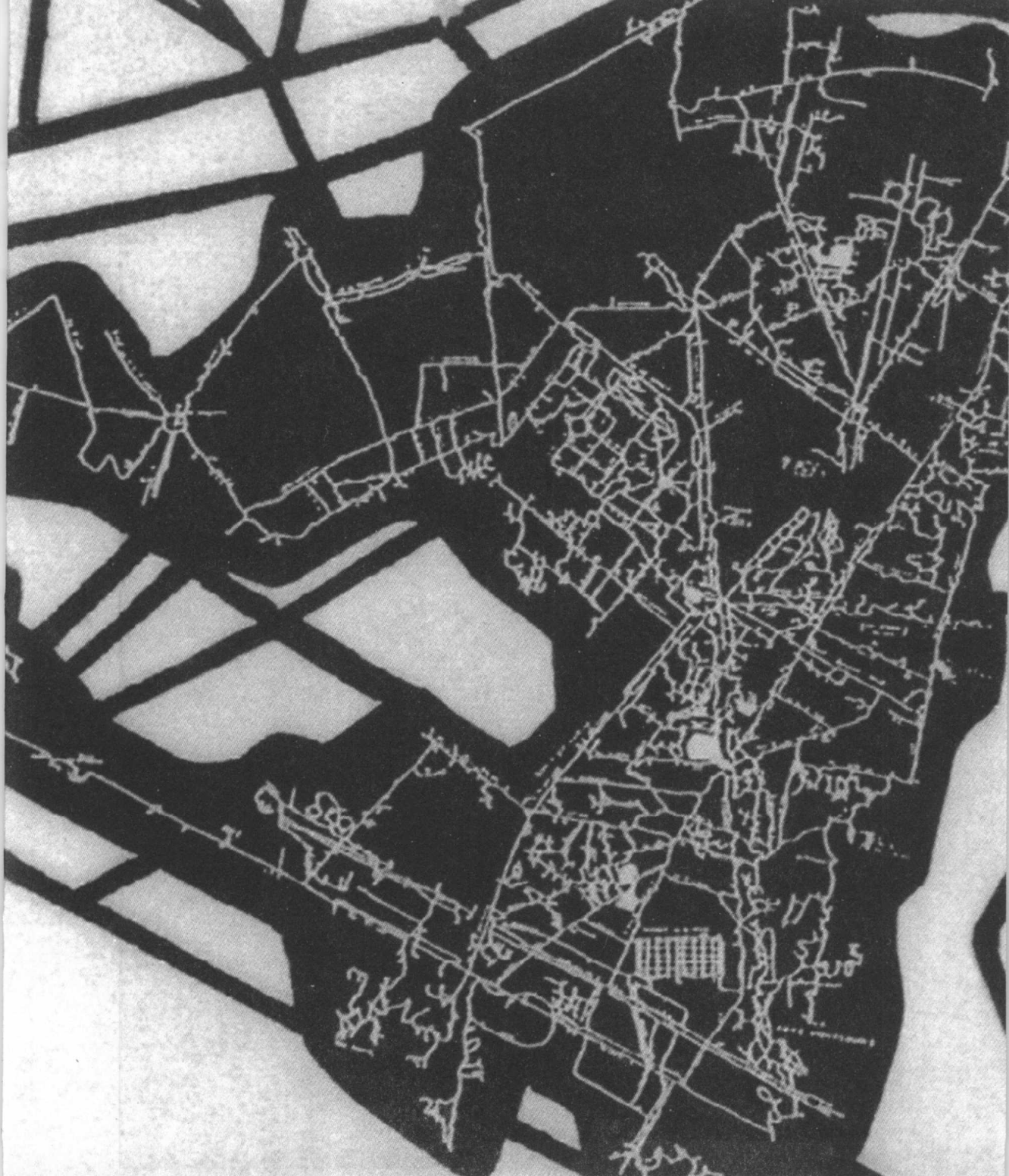
城南地下采石场大坑道系统详图，主要位于巴黎第十四区。
