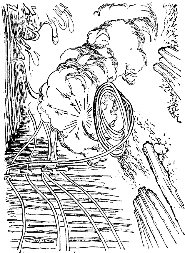
电缆放炮引起火灾。
