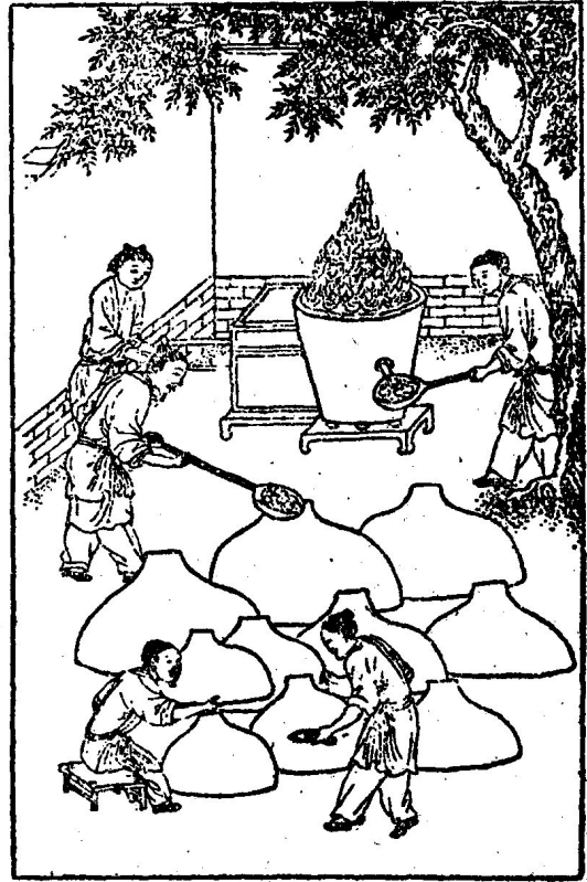
图 0—2 我国古代溶化生铁和浇注
