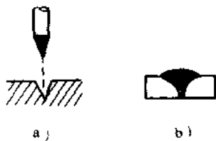
图 1-4 蘑菇状焊缝断面的形成
