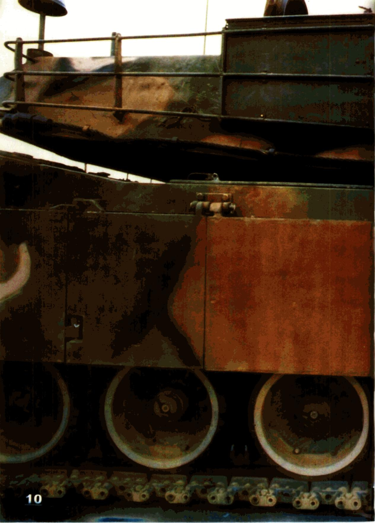
XM1样车车体中部右侧特写。车体迷彩为美国陆军的正规保护色喷漆，与以往坦克所不同，这种迷彩让人领略到无光泽表面的质感。同时可以清楚地看到从前方向后部逐渐升高的车体层面和炮塔下方的斜面，以及装甲的搭配和结合方法。
