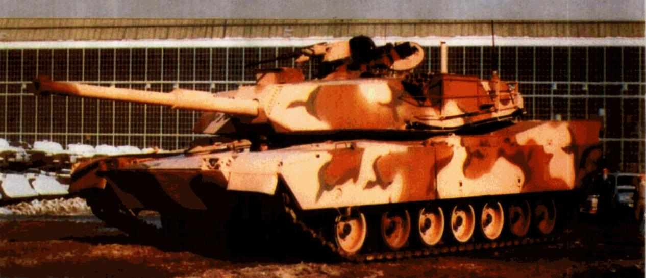
于1978年2月完成第二批试制完成的1号样车。根据与原西德的协定，在以后改进时将装备120毫米口径滑膛炮，所以设计了105毫米和120毫米口径火炮兼容的炮塔。至同年7月生产了各种试验用车11辆。
