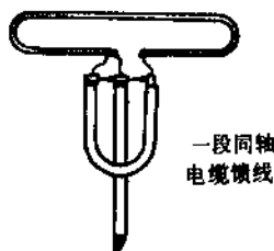
图 1—9 加接同轴电缆 馈线进行阻抗变换
