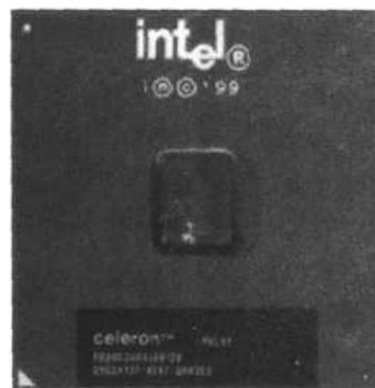
图 2.2 Intel 公司的 Celeron II 处理器
