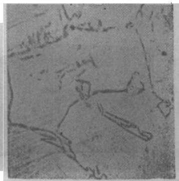
圖 229. 不銹鋼(18%Cr—9%Ni)的顯微組織, 在奧氏體晶粒邊界上有碳化物( \times 500 )。
