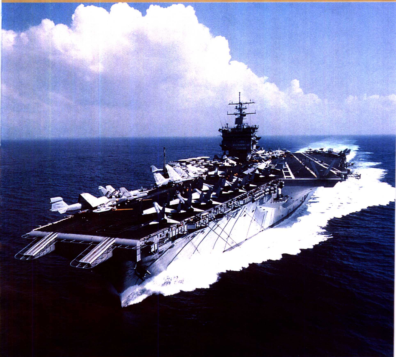
美国海军“企业”号核动力航空母舰 (CVN.65)。该舰实施了“延长物资使用期计划”，其岛形上层建筑在此期间进行了更换。
