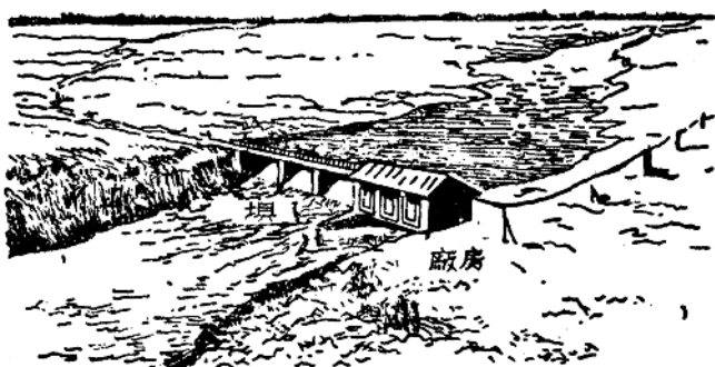
图6 壩壩式水电站
