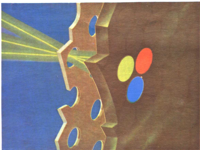
照片 1. 蔭罩式影像管剖面圖
