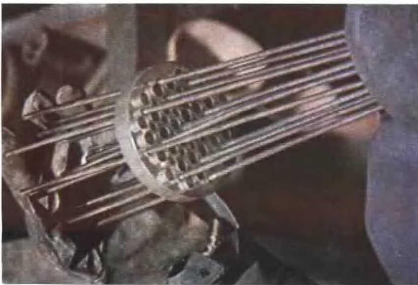
转炉复吹底吹透气 塞组装模具
