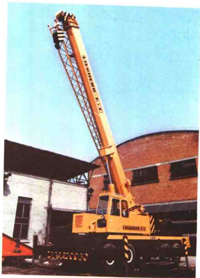
用HQ70 高强度焊接 结构钢制造的起重机吊臂
