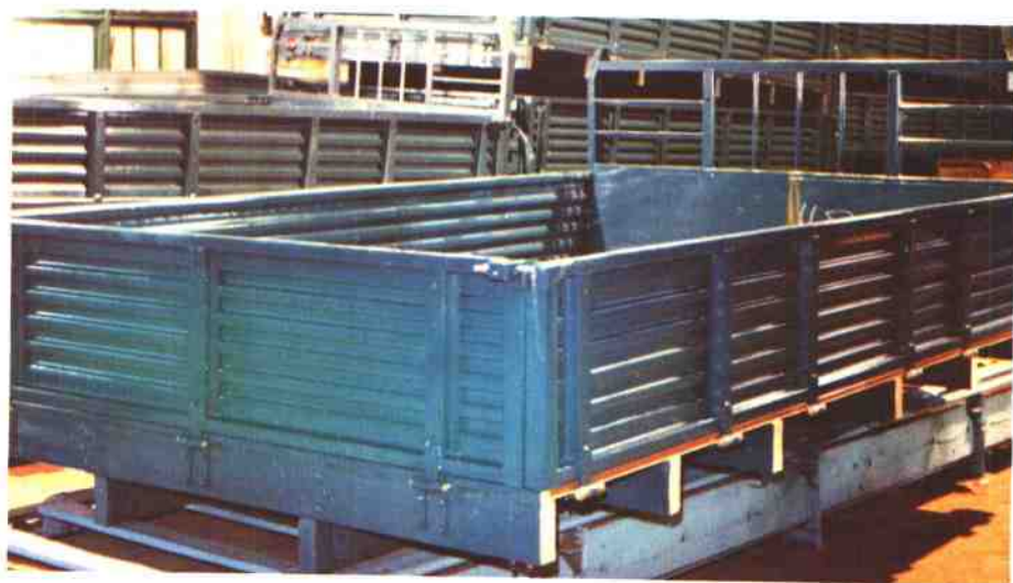
16MnRE 冷轧板制造的汽车车箱
