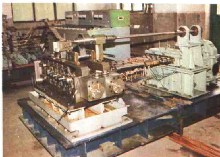
自行设计制作的立、卧式连轧机（异步轧机）
