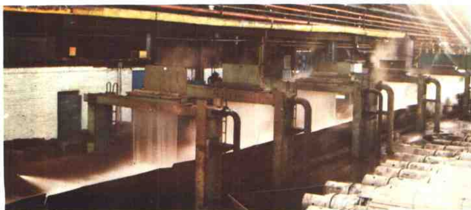
水幕冷却装置应用于半连轧厂带钢输出辊道
