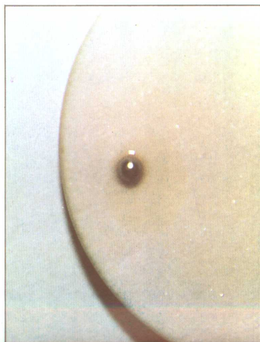
图 42 宝钢 SC-1 软钎膏印刷在白瓷片上的熔化试验,无黑色氧化物,无小锡珠飞溅,钎剂残留物呈透明的浅黄色
