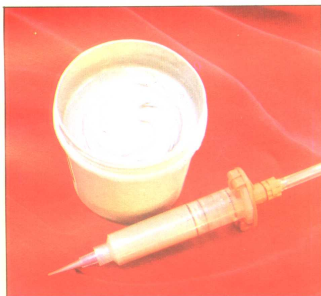
图 40 宝钢 SC-1 软钎膏外形及定量滴送筒
