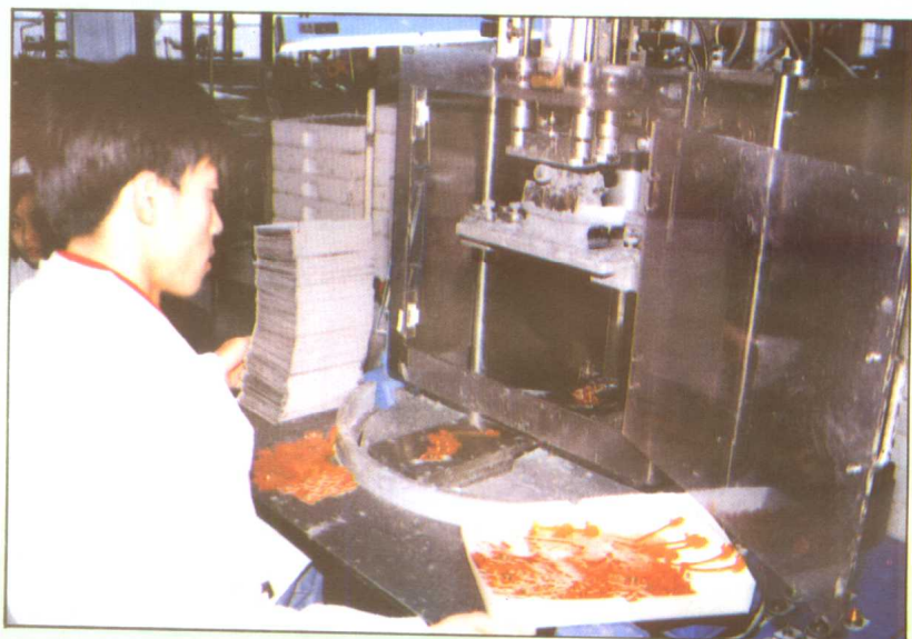
图 44 模板印刷机印刷柔性 印刷电路板
