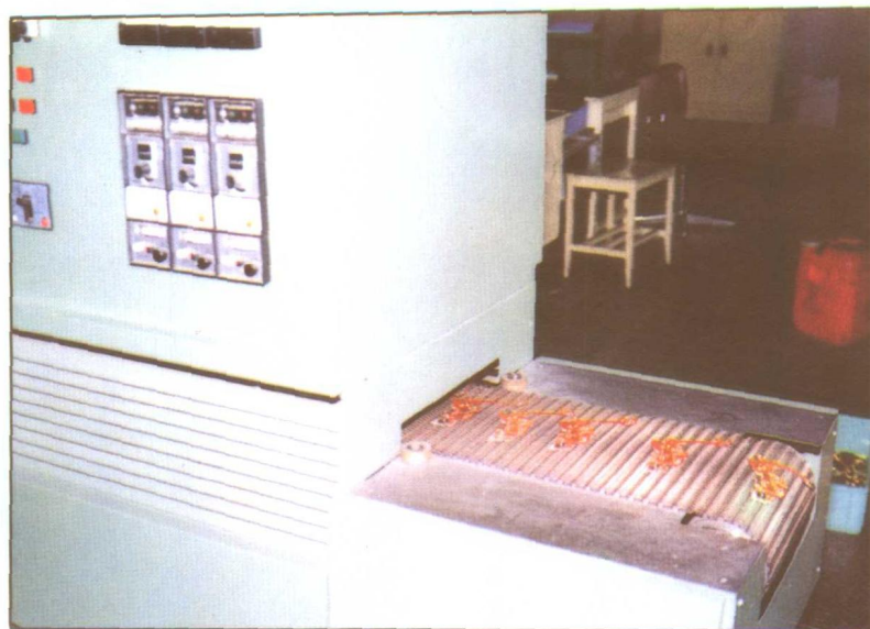
图 46 再流软钎接后的柔性 印刷电路板出炉
