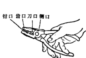
图 17 钢丝钳和它的正确握法
