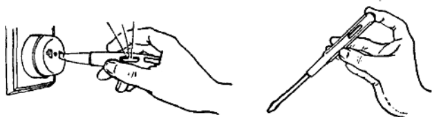
图 14 钢笔式和改锥式试电笔的使用方法
