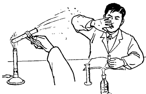
图 4. 加热时試管口不可对着人
