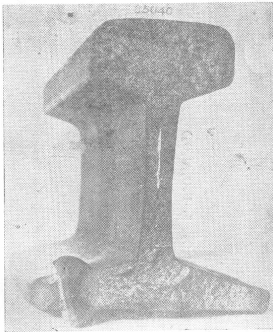
图 4—1b 有米黄色夹杂的鋼軌断面的热酸侵蚀
