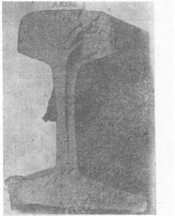
图1 鋼軌折断后断面上的分裂現象
