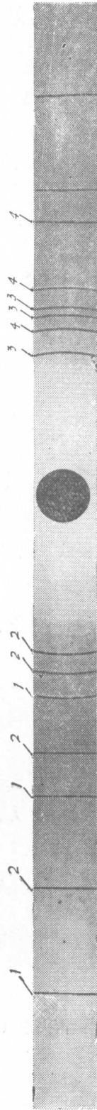
图 4—2c 缝内米黄色粉末的 X—射线
