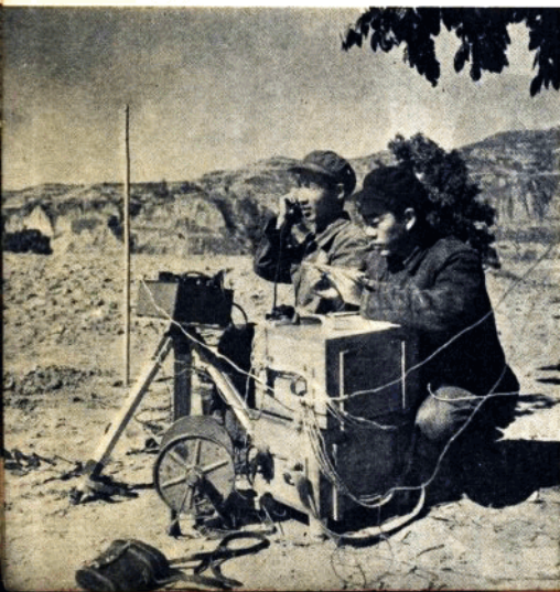
為探明三門峽壩址區右岸第四紀黃土類土壤覆蓋層的厚度，確定基岩的頂板高程，勘探人員在用電阻法進行勘探。
