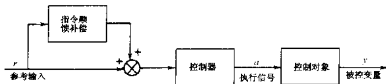
图 1-5 有指令顺馈补偿的开环控制系统
