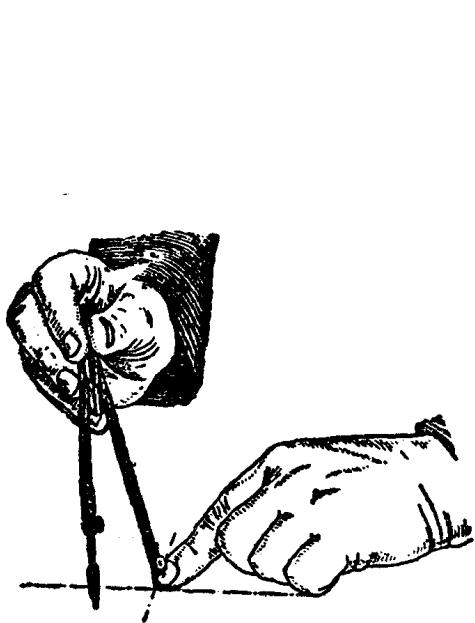
图 18 安置圆规针尖的方法
