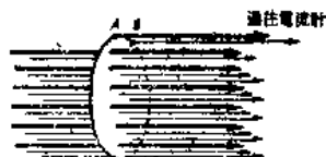
第 162 圖 通過一與磁場方向垂直的圓形導線平面的磁通量
