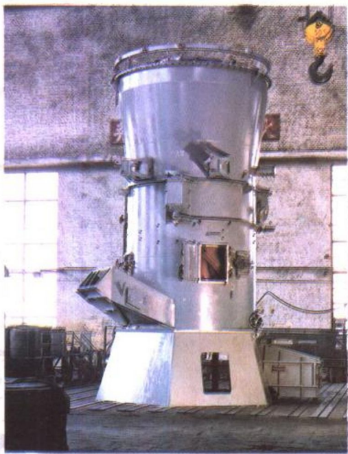
达到 90 年代初国际同类产品水平的 ZGM95 中速磨煤机
