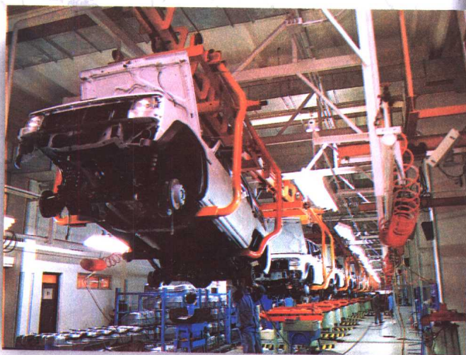
总装配生产流水线
