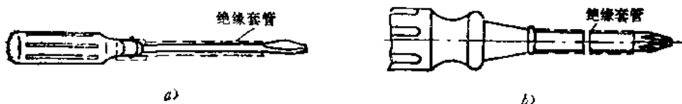
图 1-5 螺丝刀 a) 平口螺丝刀 b) 十字口螺丝刀
