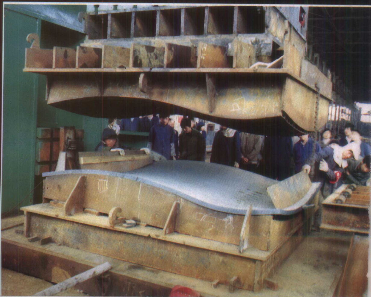
热风炉炉帽 S 弯压制
