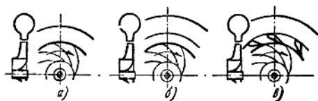
圖 303 抽水機圖式 (a) 無漩室的; (b) 有漩室的; (c) 有導環的。
